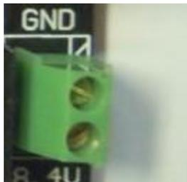
此接口输出 8.4V 电压，用于接我们后期的无线摄像头，也可接其他 8V 左右的设备。
