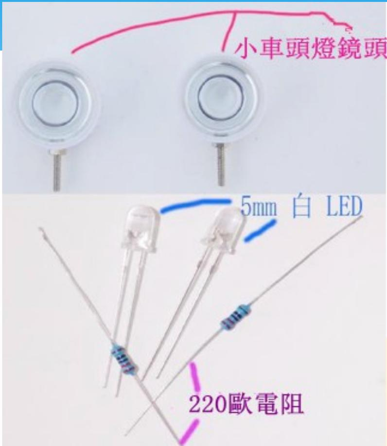
小車頭燈，是給小車提供夜間補光使用，使用 2 只 5 毫米的 LED 做為照明使用，在使用時一定要把 220 歐電阻串在 LED 的正極才能連接智慧控制板上，LED 的正極接智慧控制板的 6 腳和 7 腳，負極接 GND（LED 腳長為正，腳短為負。）
