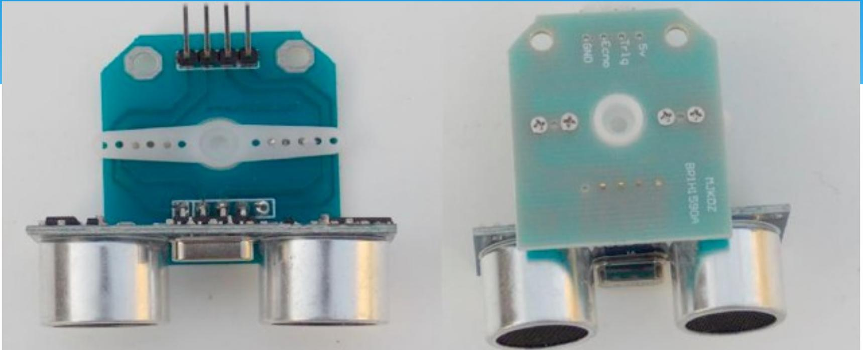
超聲波模組，在小車裏主要是避障用，防止小車撞牆，本模組有 4 個連接頭 5V 接 MCU 主控板的 5V 供電輸出，Trig 接 MCU 主控板的 9 腳，EchoMCU 主控板的 8 腳，GND 接智 MCU 主控板的 GND 供電。
