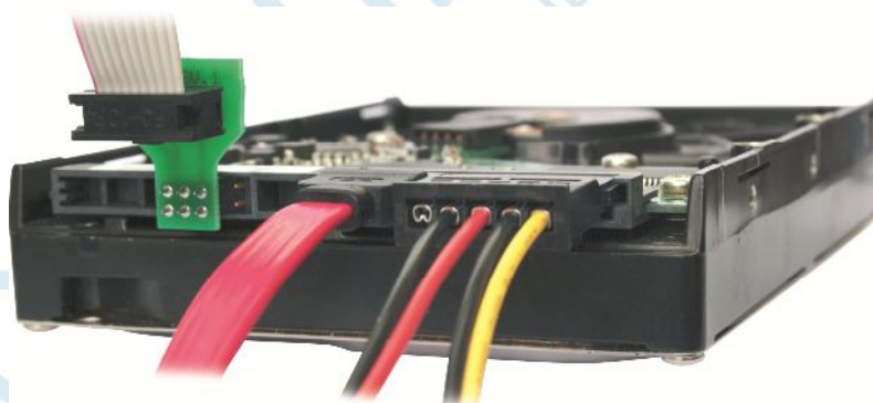
Рис. 3.6. Подключение переходника «PC-SEAGATE» к 3.5" накопителю с интерфейсом SATA.
