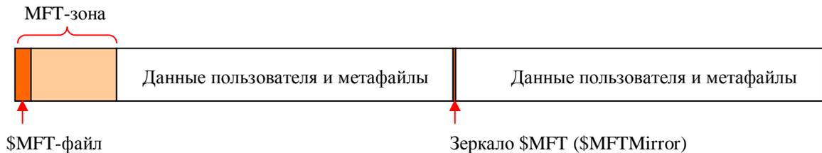
Рисунок 95 Структура дискового тома с файловой системой NTFS
